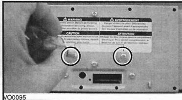
3 À l'aide d'un tournevis Robertson n° 2 ou Phillips n° 2, enlever la vis retenant le fil de rétention situé à gauche du compartiment électronique.
