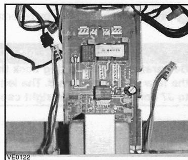
5 À l'aide d'un tournevis Robertson n° 2 ou Phillips n° 2, retirer les 2 vis les plus basses (illustrées ci-contre) et retirer le couvercle du compartiment électronique.
